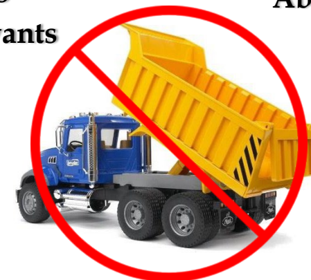
Conduire de gros véhicules près des réservoirs/du champ d'épuration
